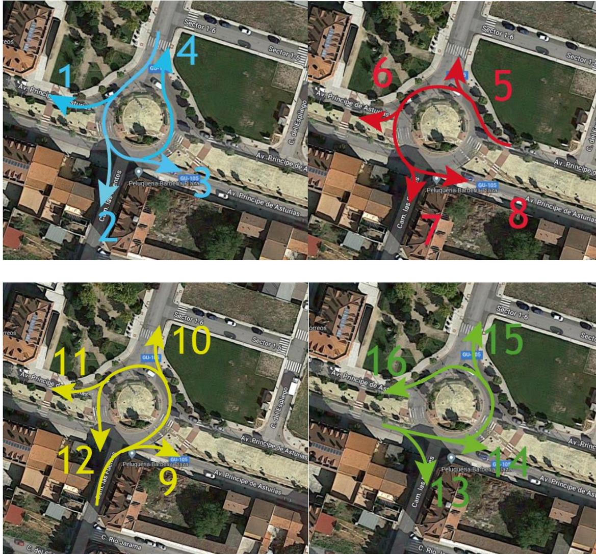
Ilustración 25. Sentidos de giro en la glorieta de Cam. de las Fuentes y Avda. de los Príncipes de Asturias
