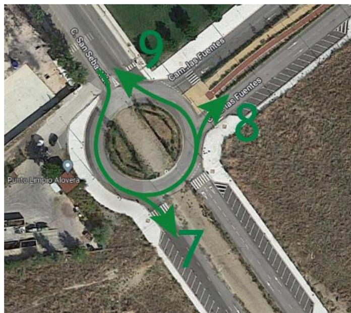
Ilustración 24. Secciones controladas en el aforo de Avda. de Cristóbal Colón, frente al punto limpio.
